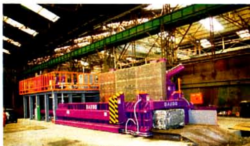
鉄スクラップ業界初のエコサーボプレス。機械が作動している時でしかポンプが駆動しないため待機電力は在来機の半分。ポンプ負荷も在来機の半分のため長寿命化・省コスト化が見込める画期的なプレス機である
