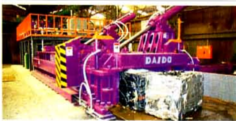
通常プレスは縦押しと横押しの圧力差から「バリ」がでやすいが、同機は独自の圧力調整からバリ発生リスクを回避した(安全な荷捌きができる)
