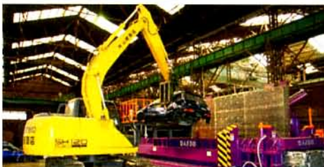
0.45のコンボでエコサーボプレスに廃車を装入中
